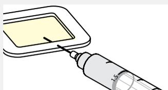
用3ml纯水填入注射器。通过海绵泡沫棉周长以大约30°到测试面的角度，将注射器插入贴片，使其穿过泡沫棉到测试的贴片。
